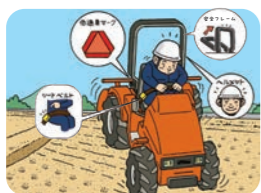
トラクターに安全フレーム装着！ 運転者はシートベルト着用！
